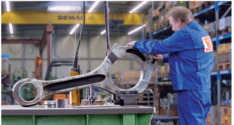
Instandsetzung einer Pleuelstange
